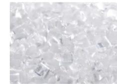
NEQAS OCEANはコットン由来のセルロース複合材料で、酢酸セルロースをベースにした生分解性に優れたバイオマス素材です。木材のようなしなやかな靱性を有しています。
