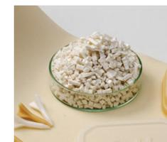
セルロースを生分解性プラスチックに混合することにより剛性(かたさ)、耐熱性を向上させた製紙会社の創る減プラの新たな可能性です。
