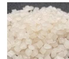
キャッサバ(タピオカ)澱粉を添加した独自のブレンドにより、高靱性・ヒンジ特性を有しています。一般的に市販されるPP系バイオマスプラスチック樹脂は成形温度が200℃以上になると焼けの発生はが起り成形難易度が高いことで知られていますが籐製品は230℃でも焼けは殆ど起こりません。
