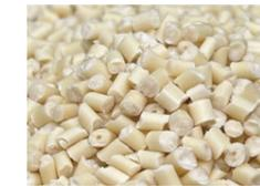
20C-HSはバイオマス度50%以上を含み、食衛法370号溶出試験に合格し、優れた耐熱性・耐衝撃性・自然環境での生分解性で安全性と環境負荷の軽減を両立しています。
